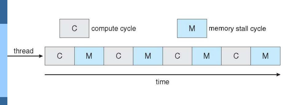
memory stall cycle : ช่วงเวลาที่ cpu ต้องรอการนำข้อมูลที่ไม่ได้อยู่ในหน่วยความจำให้ถูกload มาไว้ใน หน่วยความจำ เช่น a cache miss (ข้อมูลที่ต้องการเข้าถึง ไม่ได้อยู่ใน cache memory)
