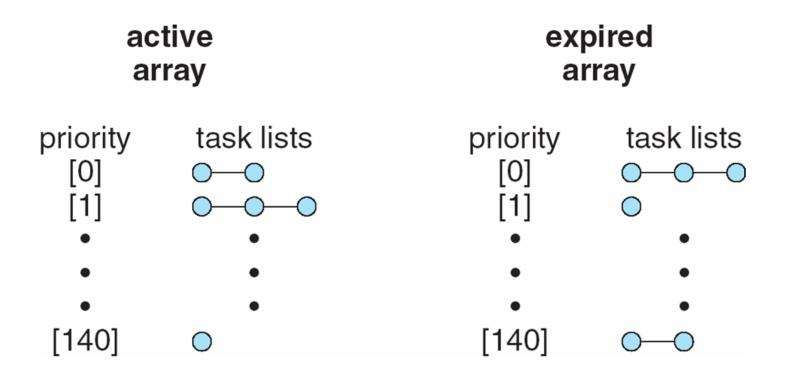
active array: เก็บ task ที่ทำงานอยู่ expired array: เก็บ task ที่หมดเวลา
